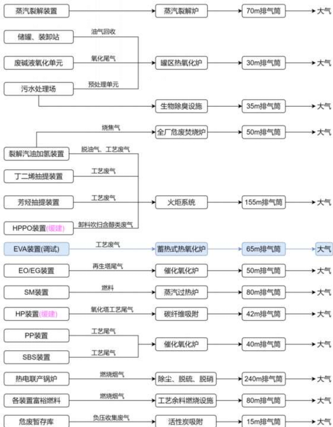
图 3.1-6 现有工程主要有组织废气排放去向图
