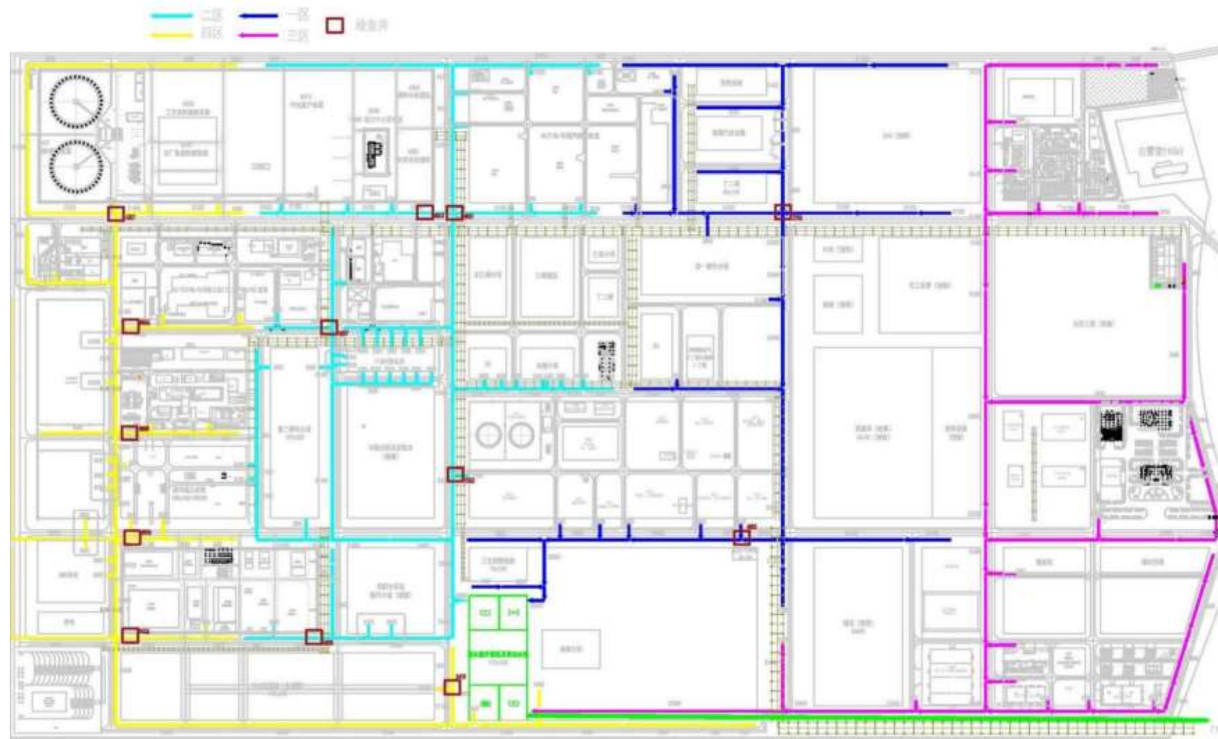
图 8.3-1 古雷石化厂内事故水及雨水收集系统示意图
