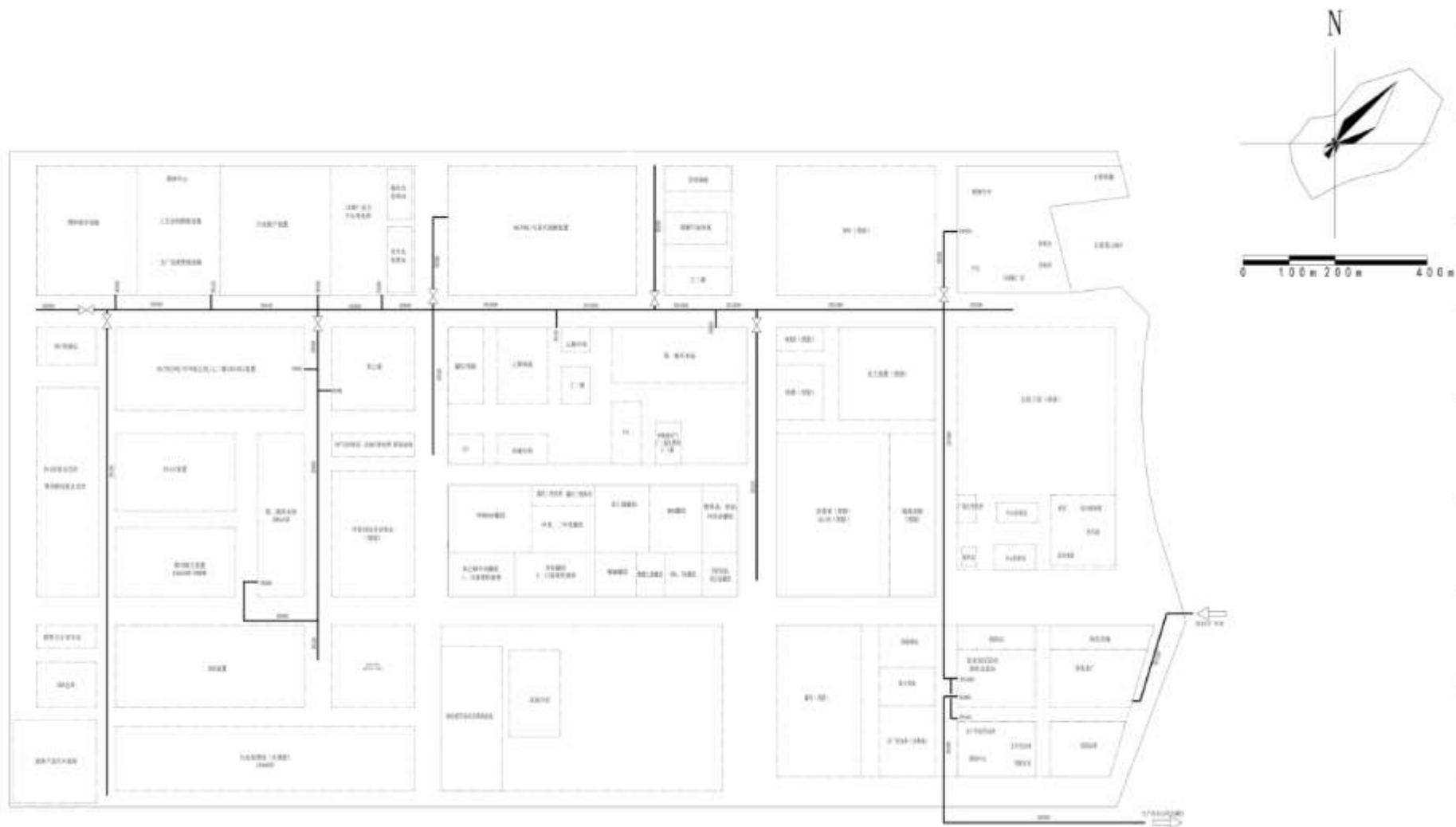
图 3.2-2 项目生产给水管网图
